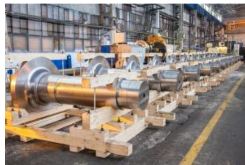
Рис. 12. «Энергомашспецсталь». Роторы для ветроэнергетических установок мощностью 1,5 МВт
