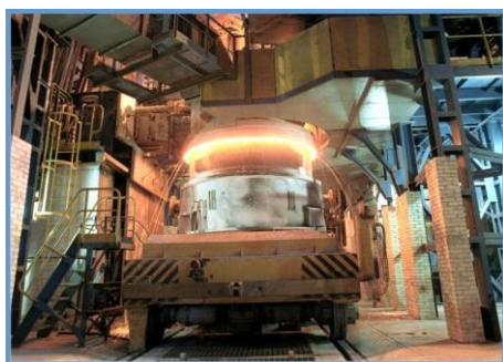
Рис. 6. «НКМЗ». Установка внепечной обработки стали «Ковш-печь»
