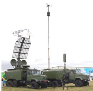
Рис. 20. Станция пассивного радиолокационного обнаружения и разведки «Кольчуга».
