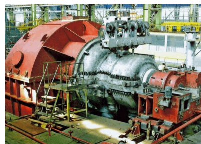
Рис. 10. Зугрес. Воздухоподогреватель для подогрева стационарных котлов с температурой подогрева 450°С
