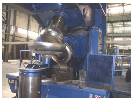
Рис. 11. Крупногабаритные днища диаметрами более 5 метров (элемент емкостного оборудования)
